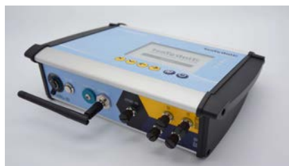
Anschlussseite mit Antennen-Anschlüssen für 4G und 433 MHz.
