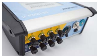
Anschlussseite: 4x Analog (S1-S4) und 4x idsBus.
