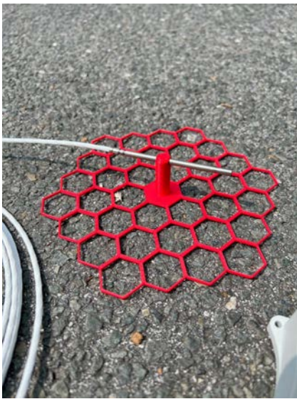
idsPTMount mit eingestecktem PT1000-Kabelfühler.
