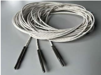
PT1000-Mantelfühler mit Edelstahlhülse, verjüngter Spitze und PFA-Leitung.
