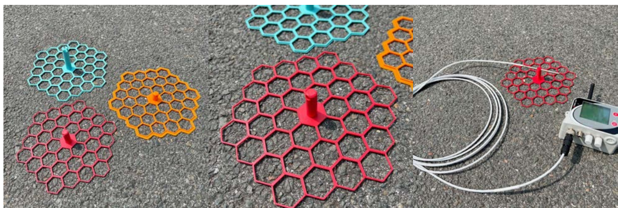
Drei Höhen, farblich unterschieden: 1,5 / 3 / 5 cm. Wabenstruktur für optimalen Verbund mit dem Asphalt. Komplettsystem: idsPTMount mit PT1000 und idsLogger.
