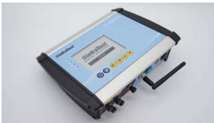
idsLoggerX2 - 4G-Datenlogger mit Antenne und Bedienpanel.
