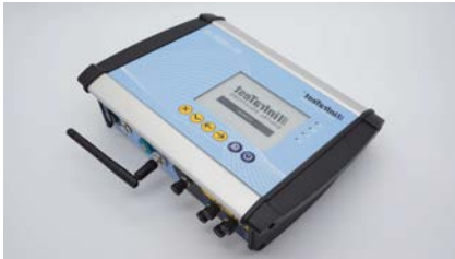
idsLoggerX3 - 4G-Datenlogger mit zusätzlicher 433-MHz-Funkanbindung.
