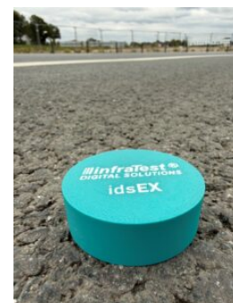
idsEX-Funksensor - wird vom X3 kabellos ausgelesen.
