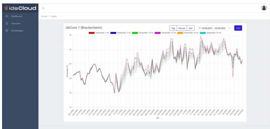
idsCloud Dashboard - Echtzeit-Visualisierung der Messdaten aus dem Bohrkern.
