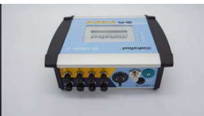
Seitenansicht mit Antennen-Anschlüssen und Ladebuchse.
